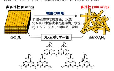
$nanoC_3N_4$ は g- $C_3N_4$  濃硫酸, 水酸化ナトリウム水溶液, アルコールで処理するのみで簡単に調製できます. 多孔質の窒化炭素はこれまでにも窒化炭素合成時に鋳型を用いる方法がありましたが, このように薬品での後処理のみで機能を持たせる手法は Post-synthesis 法と呼ばれ, 従来法に比べて大量合成に向いています. また, この合成法を用いることで通常のg- $C_3N_4$ にはない固体塩基性を与えることができます. 従来の固体塩基の多くが水への溶け出しがあるのに対し,  $nanoC_3N_4$  上の塩基点は水に溶け出さないため, これまでは難しかった水中での固体塩基触媒としての利用が期待できます.
