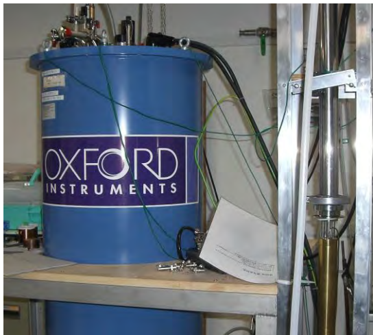
ヘリウム 3 冷凍機。0.3 K の極低温と 8T の高磁場により超伝導や磁性の評価を行う
