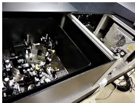
図2 自作のハイパーラマン分光装置
